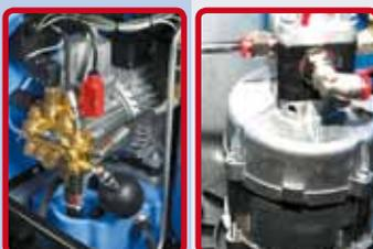
**10.** Alle unsere Heißwassergeräte besitzen 2 Motoren, einen Motor für die Hochdruckpumpe und einen Motor für Brennstoffpumpe und Lüfter. Somit werden Lüfter und Brennstoffpumpe im Kaltwasserbetrieb geschont und nicht unnötig mit angetrieben.
