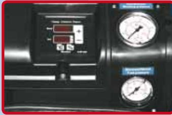
**11.** Alle unsere Heißwassergeräte haben 2 Manometer, ein Wasserdruck- und ein Öldruckmanometer.
