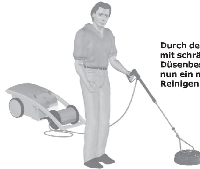
Durch den Reinigungsarm mit schräg angeordneter Düsenbestückung ist Ihnen nun ein müheloses, flächiges Reinigen garantiert.
