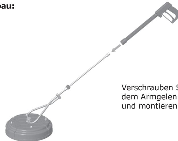
Verschrauben Sie die Lanze mit dem Armgelenk des RC 300 *light* und montieren Sie die Pistole.
