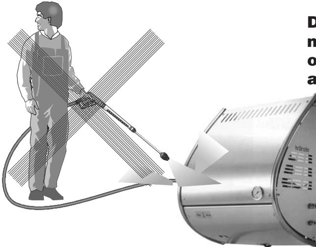
**Das Gerät nicht mit Hochdruck oder Wasserstrahl absprühen!**
