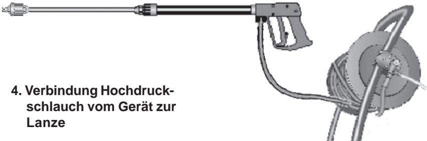
4. Verbindung Hochdruckschlauch vom Gerät zur Lanze
