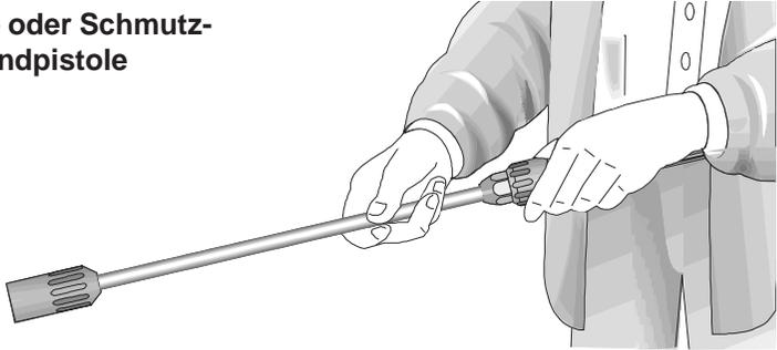
3. Hochdruckschlauch schlingenfrei abrollen und mit der Handpistole und Pumpe verbinden. Max. 20 m HD-Schlauch verwenden.
