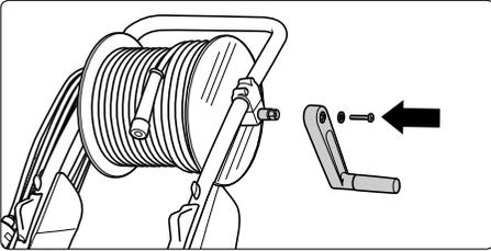
**1.** Befestigungsschraube aus dem Sechskant der Schlauchtrommel heraus-schrauben, klappbare Kurbel auf den Sechskant aufstecken und mit der Schraube befestigen.
