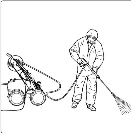
**17.** Gerät bei geöffneter Spritzpistole einschalten. Maschine entlüften: Pistole mehrmals öffnen und schließen und mit dem Waschvorgang beginnen.
