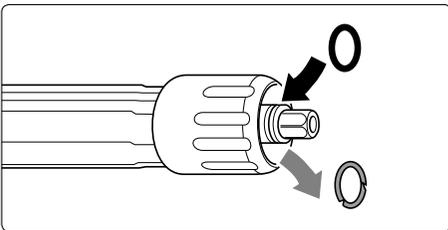
Schrauben Sie Hochdruckschlauch, Pistole und Lanze ab und kontrollieren Sie die Dichtungsringe.
