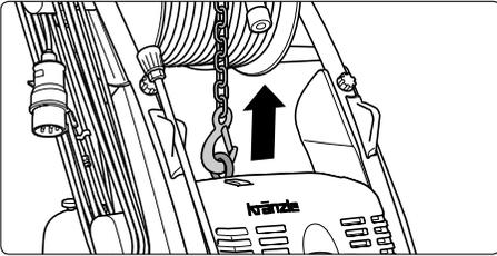
Zum Anheben der Geräte dient der zentral angeordnete Kranhaken.
