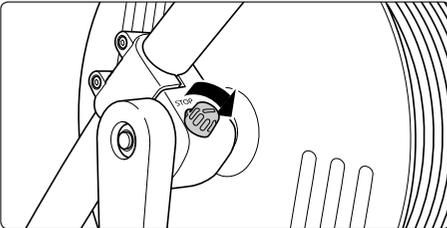
**9.** Fixierung der Schlauchtrommel lösen.
