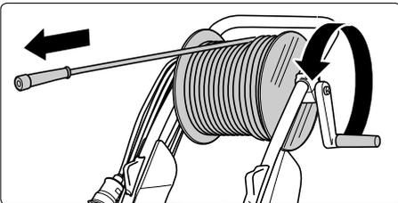
**10.** Hochdruckschlauch gerade und schlingenfrei von der Schlauchtrommel abrollen.
