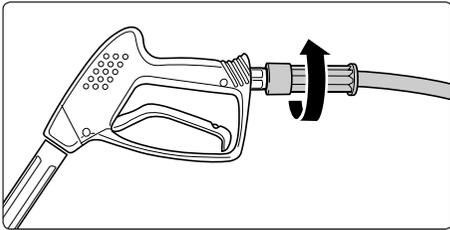
**12.** Hochdruckschlauch an der Pistole fest und druckdicht verschrauben.
