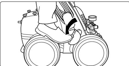
**4.** Feststellbremse lösen.
