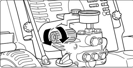
**15.** Arbeitsdruck stufenlos mit dem Handrad regeln. Der maximal verfügbare Druck ist werkseitig fest eingestellt
