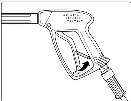
Sicherungssperre an der Pistole nach jedem Gebrauch umlegen, um unbeabsichtigtes Spritzen unmöglich zu machen!
