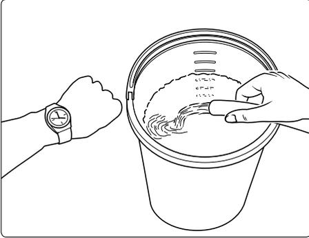
Wassermangel kommt häufiger vor als man denkt. Je leistungsstärker ein Gerät ist, umso größer ist die Gefahr, daß zu wenig Wasser zur Verfügung steht. Bei Wassermangel entsteht in der Pumpe Kavitation (Wasser-Gas-Gemisch), was in der Regel nicht oder zu spät bemerkt wird.
