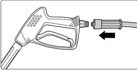
**11.** Hochdruckschlauch an die Pistole aufstecken.
