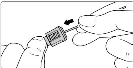
Säubern Sie die Ventile mit einem Draht (Büroklammer) und möglichst unter fließendem Wasser. Reinigen Sie auch den Ventilsitz in der Pumpe.
