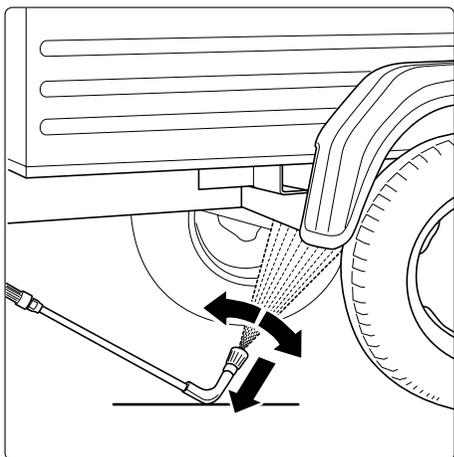
Bei der Verwendung der Unterbodenlanze die Lanze unbedingt auflegen!
