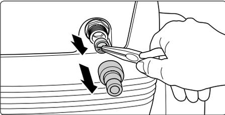
**2.** Vor jeder Inbetriebnahme **Wassereingangssieb auf Sauberkeit überprüfen.** Schlauchaufnahme per Hand abschrauben. Mit einer spitzen Zange das serienmäßige Wassereingangssieb herausnehmen und bei Verschmutzung säubern.
