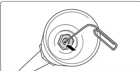
Besteht das Problem weiter, so durchstoßen Sie mit einem Draht (Büroklammer) vorsichtig die Düsenöffnung.
