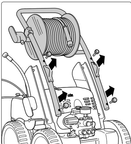
Lösen Sie die 4 Befestigungsschrauben
