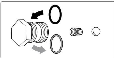
Dichtungsringe bei Defekt austauschen.
