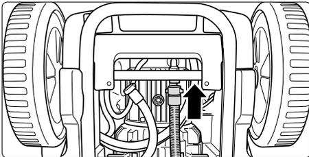
**2.** Saugschlauch an die Hochdruckpumpe anschrauben.
