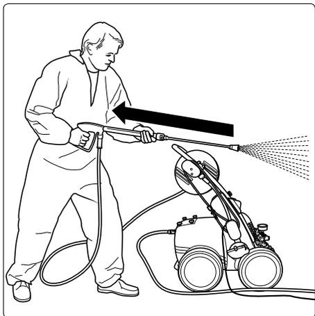
Achten Sie darauf, daß beim Reinigen mit dem Hochdruckstrahl an der Lanze ein deutlich spürbarer Rückstoß entsteht. (siehe techn. Daten S. 5/6)
