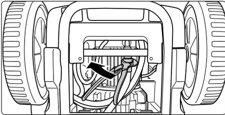
**1.** Verbindungsschlauch zwischen Hochdruckpumpe und Wasserkasten an der Pumpe abschrauben.
