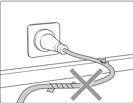
**Elektrische Kabel nur in einwandfreiem Zustand verwenden!**
