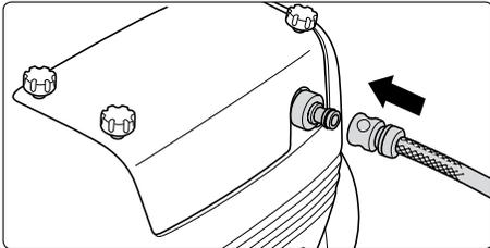
**13.** Wasserschlauch an den Wasserkasten anschließen. Das Gerät kann wahlweise an eine Druckwasserleitung mit kaltem oder bis zu 60 °C warmen Wasser angeschlossen werden.
