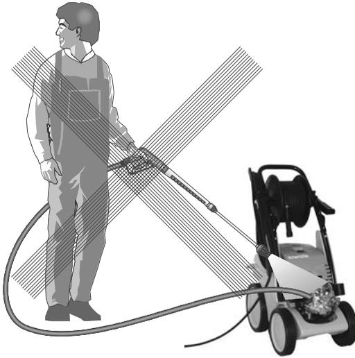
**Das Gerät nicht mit Hochdruck- oder Wasserstrahl absprühen!**
