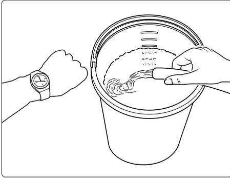
Wassermangel kommt häufiger vor als man denkt. Je leistungsstärker ein Gerät ist, umso größer ist die Gefahr, daß zu wenig Wasser zur Verfügung steht. Bei Wassermangel entsteht in der Pumpe Kavitation (Wasser-Gas-Gemisch), was in der Regel nicht oder zu spät bemerkt wird. **Die Pumpe wird zerstört.**
