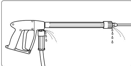
Schalten Sie das Gerät ab. Betätigen Sie zum Druckabbau kurz die Pistole.
