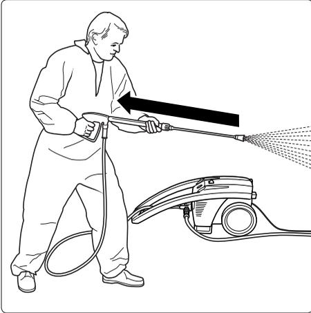
Achten Sie darauf, daß beim Reinigen mit unter Hochdruck stehendem Wasser an der Lanze ein deutlich spürbarer Rückstoß entsteht. (siehe techn. Daten S. 4)
