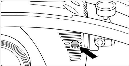
3. Vor jeder Inbetriebnahme **Ölstand am Ölschauglas überprüfen**. (Waagerechte Position beachten!) Ölstand muß in der Mitte des Ölschauglases sichtbar sein.
