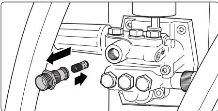
Rückschlagkörper entnehmen und auf Verschmutzung oder Beschädigung des Dichtungsringes überprüfen.
