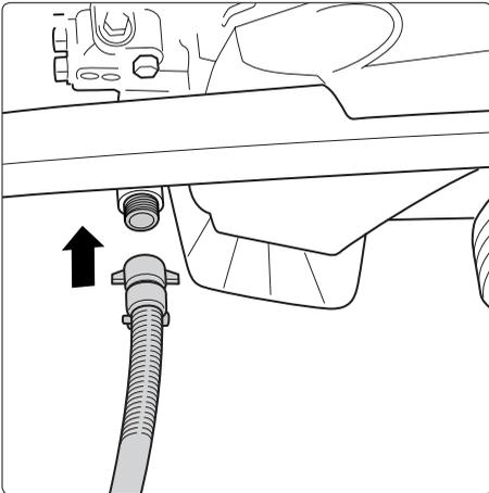
Saugschlauch aufmontieren. Der Schlauchinnenquerschnitt muß mindestens  $3/4'' = 16 \text{ mm}$  aufweisen.
