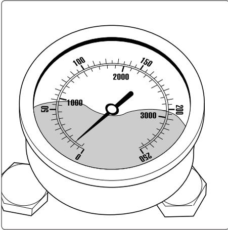
Das Manometer zeigt trotz aufgedrehter Druckregulierung nur wenig Druck, aus der Lanze kommt ein unregelmäßiger Strahl. Der Hochdruckschlauch vibriert.
