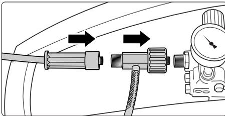
**1.** Hochdruckschlauch abschrauben, Reinigungsmittelinjektor auf den Hochdruckausgang aufschrauben und mit dem Hochdruckschlauch verbinden.
