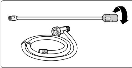
Dazu ist der Einsatz der Saugset-Lanze mit verstellbarer Regeldüse von Hoch- zu Niederdruck nötig, da der Ansaugvorgang nur bei Niederdruck funktioniert. Durch Verstellen der Regeldüse auf Hochdruck wird die Chemiezufuhr gestoppt.
