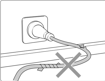
**Elektrische Kabel nur in einwandfreiem Zustand verwenden! Kabel nicht beschädigen oder unsachgemäß reparieren!**
