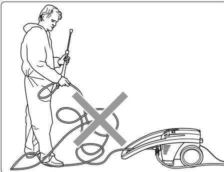
**Hochdruckschlauch nicht knicken und nicht mit Schlingen ziehen! Hochdruckschlauch nicht über scharfe Kanten ziehen!**
