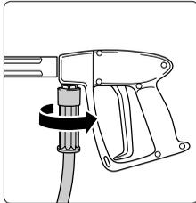
**7.** Hochdruckschlauch an die Pistole aufstecken.
