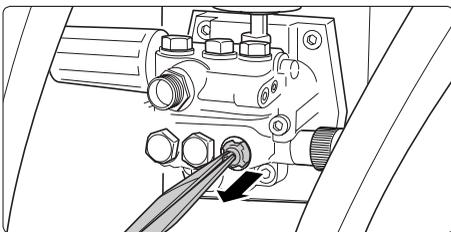
Entnehmen Sie die Ventilkörper (mit grüner oder roter Plastikummantelung) samt O-Ring mit einer spitzen Zange. Kontrollieren Sie den Dichtungsring auf Beschädigung. Bei Beschädigung muß der O-Ring ausgetauscht werden.
