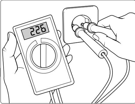
Sind in Ihrer Leitungsumgebung gleichzeitig zuviele Stromabnehmer am Netz, können die zur Verfügung stehende Spannung sowie die Stromstärke deutlich sinken. In der Folge läuft der Motor des Hochdruckreinigers nicht an oder brennt gar durch.
