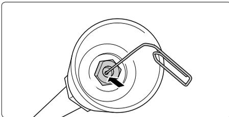
Sollte das Reinigen mit einem Draht nicht den gewünschten Erfolg bringen, so muß die Düse im ausgebauten Zustand gereinigt oder ggf. ersetzt werden.
