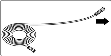
**6.** Hochdruckschlauch gerade und schlingenfrei ausrollen. (Bei Verlängerung des Hochdruckschlauches die maximale Länge von 20 m beachten!)
