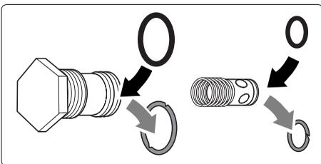
Dichtungsringe bei Defekt austauschen.
