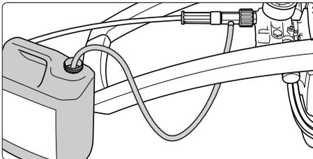
**3.** Gerät bei geöffneter Pistole einschalten und die Regeldüse der Lanze auf Niederdruck stellen. (Reinigungsmittel-Zumischung 3 - 5 %)
