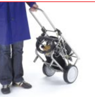
Zum Transport des Gerätes wird der Fahrbügel ausgeklappt und in Fahrposition arretiert.
