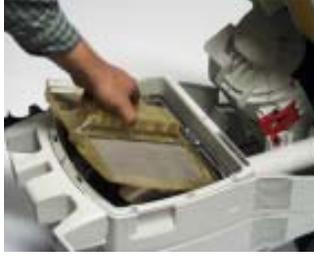
Ziehen Sie den Deckel nach hinten aus dem Schmutzbehälter.
