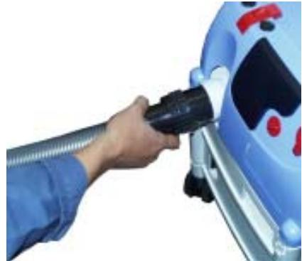
3. Saugschlauch schlingenfrei auslegen
