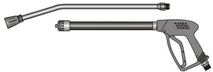
Durch Betätigung des Hebels wird die Spritzpistole geöffnet. Die Flüssigkeit wird dann zur Düse befördert. Der Spritzdruck baut sich auf und erreicht schnell den gewählten Arbeitsdruck.
