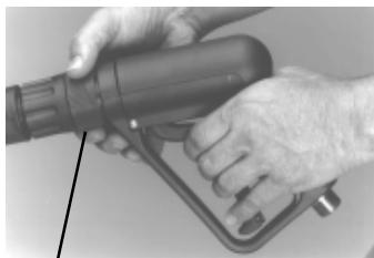
Die Spritzpistole ist mit einer eingebauten Druckregulierung ausgestattet. Dreht man den roten Ring am Griff (Pos. 3) nach rechts verringert sich der Spritzdruck, dreht man ihn nach links erhöht sich der Druck wieder. Am Manometer wird jedoch der am Regelventil eingestellte Druck angezeigt.
